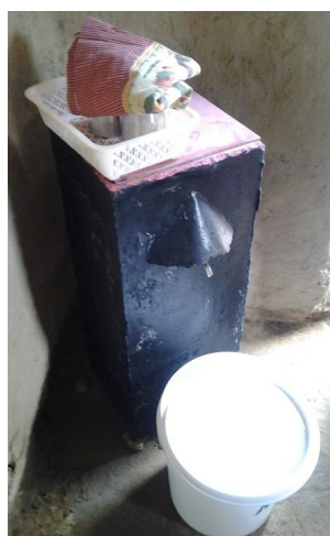
Type de « filtre canadien » pour la production d'eau potable
